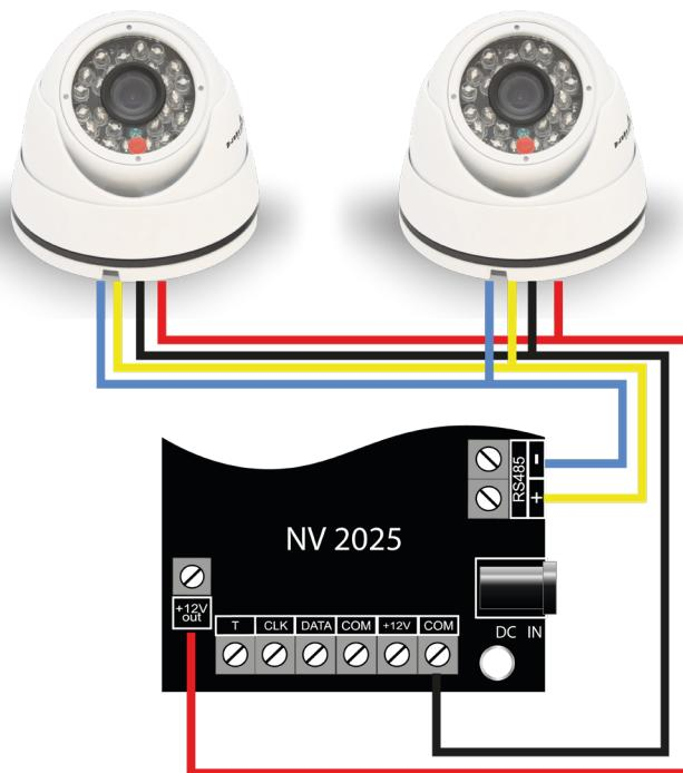
Рисунок 3. Подключение камер NV DOM 485-28IR к NV 2025
