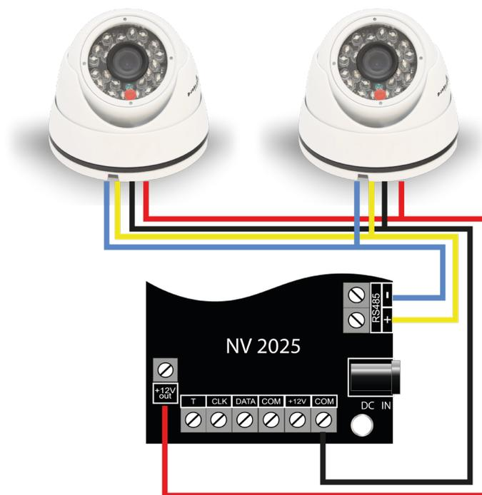
Рисунок 3. Подключение камер NV DOM 485-28IR к NV 2025
